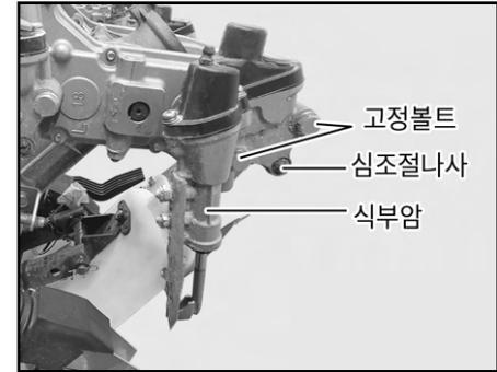
3. 로타 케이스를 수동으로 회전시켜 식부침 끝단이 게이지의 「중」 위치에 맞는지 확인하여 주십시오. 로타 케이스를 수동으로 회전시킬 경우는 6장의 「로타 케이스의 수동 회전 방법」의 요령으로 확인하여 주십시오.
