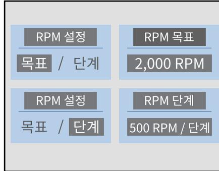
멀티 크루즈 레버의 목표 RPM 및 단계 RPM을 설정할 때 사용합니다.
