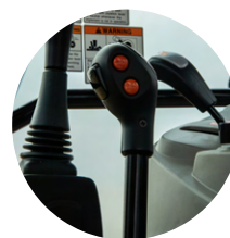
4. Main shift D clutch
